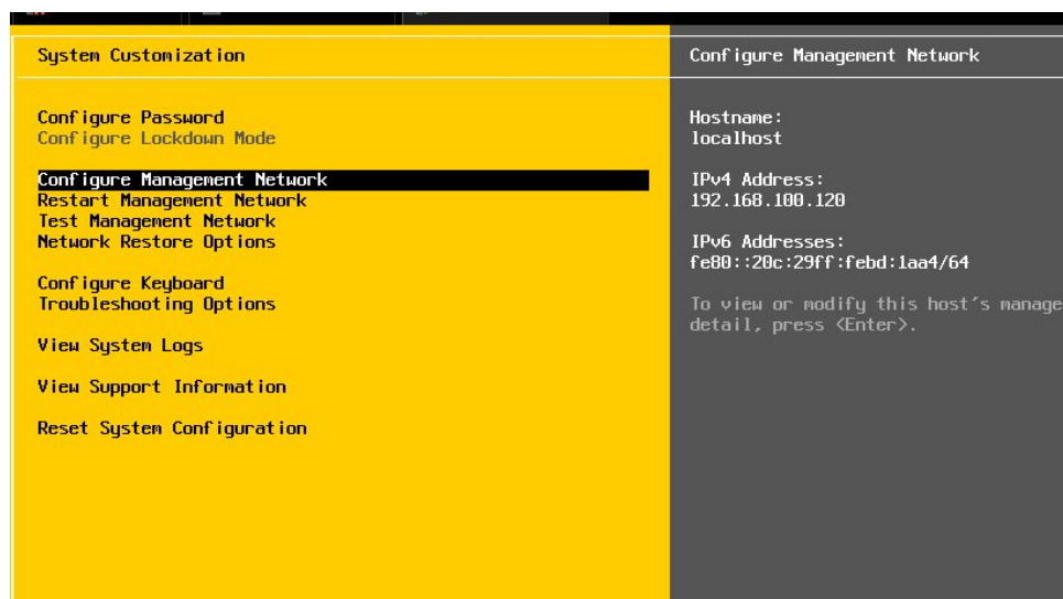
Figure 1.2 – Configuration du réseau de gestion ESXi — assignation de l'adresse IP, masque et passerelle depuis le menu DCUI (Direct Console User Interface)
